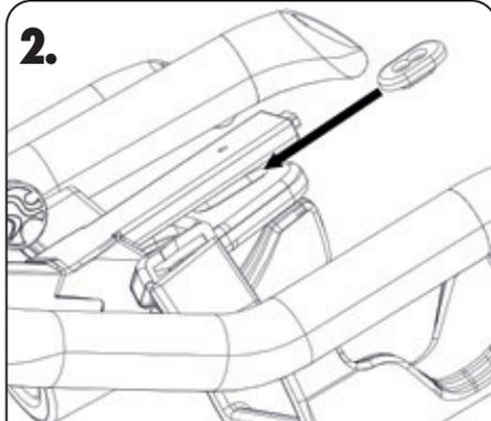
SCHIEBEN SIE DEN ABSTANDSHALTER ZWISCHEN DEN LENKER UND DIE COMPUTERHALTUNG. DER ABSTANDSHALTER PASST GENAU IN DIE NUT AM LENKER.
