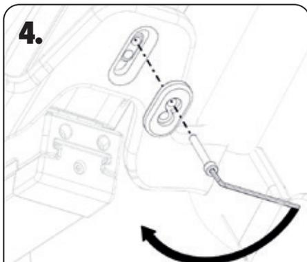
BEFESTIGEN SIE DEN ZWEITEN ABSTANDSHALTER AN DER AUSSENSEITE DES LENKER MIT DER MITGELIEFERTEN SCHRAUBE UND EINEM 3MM INBUSSCHLÜSSEL.
