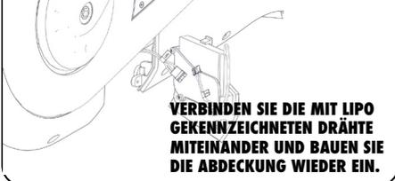
VERBINDE SIE DIE MIT LIPO GEKENNZEICHNETEN DRÄHTE MITEINANDER UND BAUEN SIE DIE ABDECKUNG WIEDER EIN.
