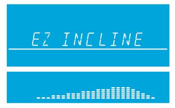
EZ Incline besteht aus einem Hügel. Die Höhe des Hügels wird von Ihnen bei der Programmierung bestimmt. Der höchste Punkt des Hügels wird nach 75 % der Trainingsdauer erreicht. Anschließend kehrt der Widerstand oder die Steigung allmählich wieder auf Stufe 1 bzw. 0 % zurück.
