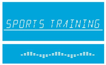
Sport Training simuliert das Training im Freien, indem es eine Basislinie verwendet, um ein flaches Gelände zu simulieren. Das Programm simuliert dann Bergaufbewegung mit Werten über dem Grundwert und Bergabbewegung mit Werten unter dem Grundwert. Die Einstellungen über und unter der Basislinie bestehen aus Änderungen des Widerstands bzw. der Steigung. Sie bestimmen die Geschwindigkeit.
