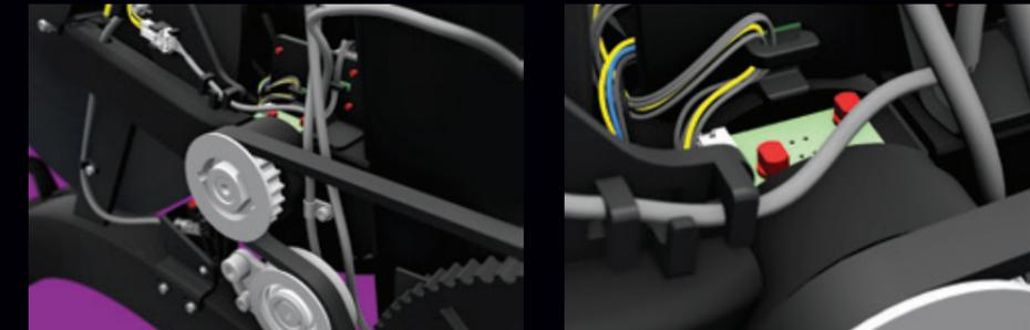
Das IC7 verfügt über eine einzigartige Technologie zur Messung der Leistung in Watt. Dabei misst das WattRate<sup>®</sup> Direct Power Meter die Torsion (Verwindung) der Zwischenwelle über Lichtschranken. Diese direkte Messung ermöglicht eine höchste Messgenauigkeit mit einer Abweichung von nur +/- 1 %. Außerdem ist das System widerstandsfähig gegen äußere Einflüsse wie z.B. Temperatur, Luftfeuchtigkeit und Transport, weshalb keine Rekalibrierung erforderlich ist.
