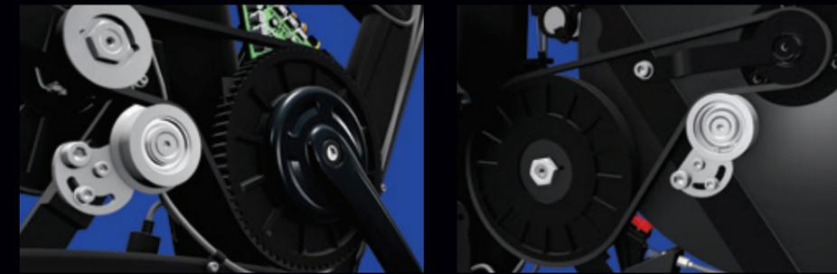
Das einzigartige Übersetzungsverhältnis von 1:11 mit einer Kombination aus Keil- und Zahnriemen überträgt auch extreme Kräfte effektiv und sorgt dabei für eine perfekte Beschleunigung sowie optimale Massenträgheit der Schwungscheibe. Dies schafft eine direkte Verbindung zwischen Benutzer und Rad und realisiert dadurch ein perfektes Fahrgefühl.
